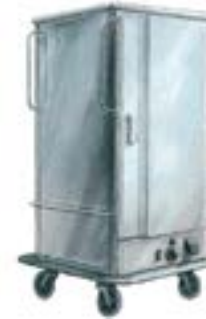
411 Armario caliente 150° vent/humid. 220 V / 16A monofásica - 2,2 kW. Temperatura maxi : 150 °C en 50 min. Se suministra con 8 rejillas gn 2/1 (65 x 53 cm). Espacio entre los rejillas : 10,5 cm. Bloque de ventilación con superposición de un recipiente gn 2/1. Ext. : L 77 ; I 93 ; Alt. 162 cm. 135 Kg
