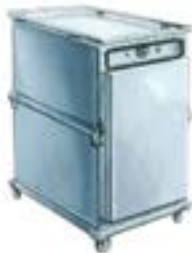
9938 Armario caliente ventilado 8 rejillas Eléctrico 220 V / 16A monofásica - 3 kW. 1 toma. Temperatura maxi : 250°C en 60 min. Se suministra con 8 rejillas 60 x 40 cm. Espacio entre los rejillas : 7 cm. Ext. : L 65 ; l 105 ; Alt. 132 cm. Int. : L 40,5 x l 60 x Alt. 85,5 cm 150 Kg
