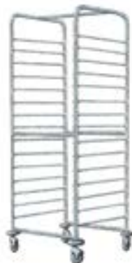
557 Carro portabandejas equipado con 15 rejillas 60 x 40 cm. Espacio entre las rejillas : 8 cm. Ext. : L 67 ; l 45 ; Alt. 171 cm. 37 Kg
