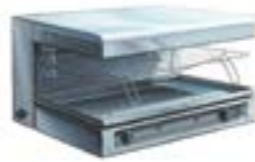
791 Salamandra 220 V / 4,5 kW repartidos en 2 tomas de 2,25 kW. 10013 Salamandra 380 V / 32A trifásico toma P 17. 1 rejilla. Ext. : L 80 ; P 45 ; Alt. 54 cm. Int. : L 59 ; P 35 ; Alt. 26 cm. 27 Kg
