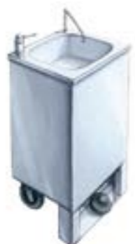
9500 Lavamanos de pedal Equipado con 1 bidón de reserva de agua (20 litros), 1 bidón para recuperar el agua usada (20 litros), 1 bidón de jabón (15 cl) Ext. : L 42 ; A. 36 ; Alt. 100 cm. 20 Kg.
