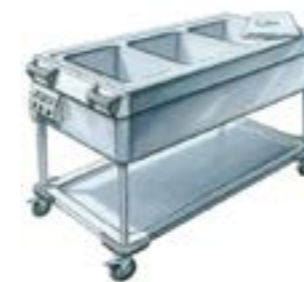
395 Baño maría eléctrico 220 V / 16A monofásica - 2,5 kW. Tiempo de calentamiento en seco : 30 min. El control de los compartimentos es independiente. Termostato regulable de 30°C a 95°C. Se suministra con 3 cestas gn 1/1. Ext. : L 122 ; I 70 ; Alt. 90 cm. 55 Kg
