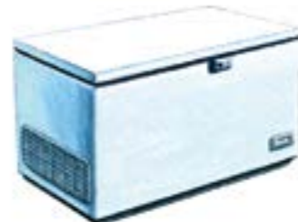
404 Congelador 560 litros 220 V / 16A monofásica - 290 W. Potencia de congelación : 30 Kg / 24 h. Ext. L 165 ; P 81 ; Alt. 89 cm. 75 Kg
