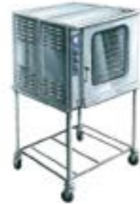
397 Horno ventilado humidificado 380 V / 32A trifásico - 16 kW - Toma P 17. Reserva de agua autónoma, capacidad 3 L. Regulación termostática de 50 a 270°C. Se suministra con 10 rejillas gn 1/1 (53 x 32,5 cm). Espacio entre las rejillas : 6 cm. Ext. : L 96 ; I 108 ; Alt. 165 cm. Int. : L 69 ; I 41 ; Alt. 53 cm. 180 Kg
