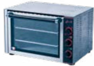
474 FHorno profesional eléctrico modelo pequeño 220 V - 2,5 kW. Regulación termostática de 0° a 250°. Minutero. Se suministra con una rejilla y una placa. Ext. : L 60 ; I 45 ; Alt. 35 cm. Int. : L 33 ; I 35 ; Alt. 27 cm. 30 Kg
