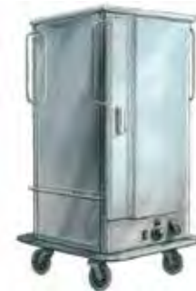
411 Armario caliente ventilado humidificado 8 rejilla 220 V / 16A monofásica - 2,2 kW. Temperatura maxi : 150 °C en 50 min. Se suministra con 8 rejillas gn 2/1 (65 x 53 cm). Espacio entre los rejillas : 10,5 cm. Bloque de ventilación con superposición de un recipiente gn 2/1. Ext. : L 77 ; I 93 ; Alt. 162 cm. 135 Kg
