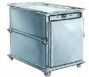
10024 Armario caliente ventilado 16 rejillas Eléctrico 220 V / 16A monofásica - 3,6 kW. 1 prise. Temperatura maxi : 200°C en 90 min. Se suministra con 16 rejillas. Ext. : L 79 ; I 125 ; Alt. 130 cm. Int. : L 60 ; I 80 ; Alt. 85 cm. 217 Kg
