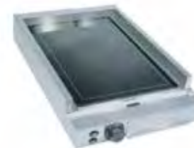
15634 Placa para hamburguesa vitro-cerámica 220 V - 2,5 kW. L 40 P 65 Alt. 10 cm. 15 Kg Superficie : 32 x 47,8 c Cocina vitrocerámica. 1 recuperador de grasa, 1 termostato, 1 piloto luminoso de control. Calentamiento rápido. Bajo consumo
