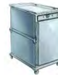
9938 Armario caliente ventilado 8 rejillas Eléctrico 220 V / 16A monofásica - 3 kW. 1 toma. Temperatura maxi : 250°C en 60 min. Se suministra con 8 rejillas 60 x 40 cm. Espacio entre los rejillas : 7 cm. Ext. : L 65 ; I 105 ; Alt. 132 cm. Int. : L 40,5 x I 60 x Alt. 85,5 cm 150 Kg
