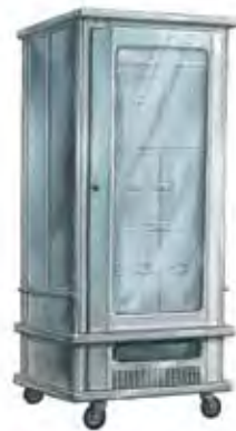
445 Armario refrigerado ventilado 400 L 220 V / 16A monofásica - 320W. + 1 a + 4° C. Se suministra con 5 rejillas gn 2/1 (65 x 53 cm). Ext. : L 76 ; l 94 ; Alt. 186 cm. Int. : L 56 ; l 67 ; Alt. 115 cm. 146 Kg
