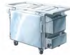
11527 Armario caliente eléctrico modelo pequeño 220/230 V - 16 A monofásica - 2 kW Temperatura maxi 150°C en 30 min - Combinado adaptable pastelería o gastronorm 1/1. Se suministra con 5 rejillas pasteleras 60 x 40 cm. Espacio entre los rejillas : 7 cm. Ext. : L 89 ; P 50,5 ; Alt. 73 cm. Int. : L 60 ; P 40 ; Alt. 45,5 cm
