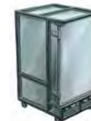
409 / 229 Armario caliente Morice Se suministra con 8 rejillas. Espacio entre los rejillas : 8 cm. Ext. : L 74 ; I 96 ; Alt. 135 cm. Int. : L 60 ; I 80 ; Alt. 95 cm. 143 Kg Gas (0229) : 1 botella de gas butano (20 Kg). Descompresor de 28 mbar. Equipado con una sonda termostática para el gas, se detiene a 180°C y se vuelven a encender a 160°C. Eléctrico (0409) : 220 V / 16A monofásica - 4,5 kW. Repartido en 1 toma de 1,5 kW y 3 kW.
